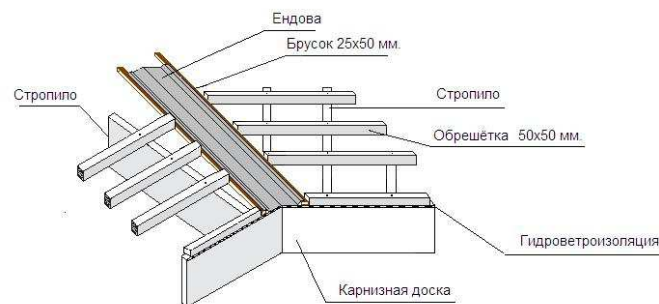
Вариант монтажа ендовы без контробрешётки
